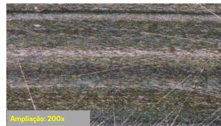
Imagens microscópicas do anel do rolamento, Castrol X320 sem adição de REWITEC®
