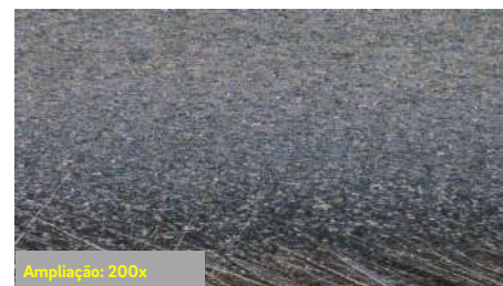
Imagens microscópicas do anel do rolamento, Castrol X320 com adição de REWITEC®
