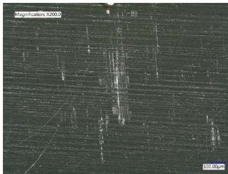
Superfície depois 4 semanas Sa: 0.19 \mu\text{m} Sz: 1.21 \mu\text{m}
