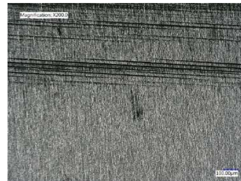
Superfície depois 8 semanas Sa: 0.12 \mu\text{m} Sz: 0.68 \mu\text{m}
