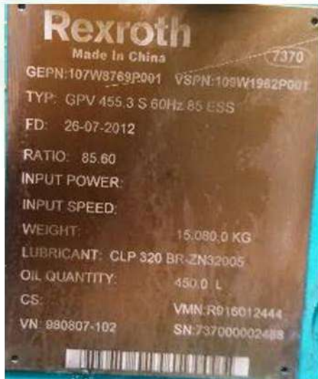
Placa de identificação do gearbox nº 730000002488 no parque eólico Asa Branca ABVIII
