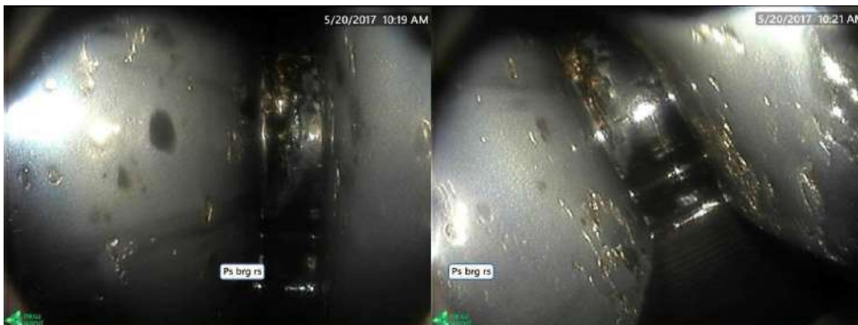
Imagem 6: Pista interna e elemento rodante do rolamento – lado do gerador, depois do tratamento
