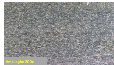
Imagens microscópicas de elementos rolantes do rolamento, Castrol X320 com adição de REWITEC®
