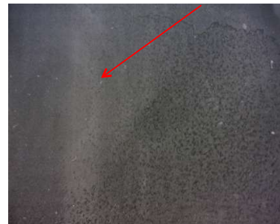
12 meses após do tratamento da turbina eólica com REWITEC®
